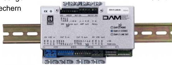
DAM Lautsprechermodul mit CAT-5 (in), CAT-5 (out), Lautsprecher- und Schalteranschlüssen
